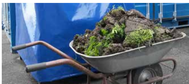
Restschlammmenge nach Entwässerung von 5 m³ Belebtschlamm über einen Zeitraum von 3 Monaten. System KLARO One, SBR Becken System KLARO
